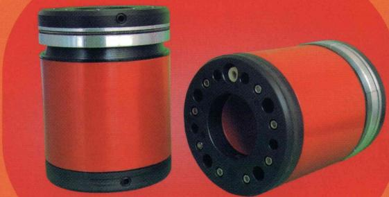
Le testate pneumatiche autocentranti RED-CHUCK sono le uniche con questa caratteristica e possono essere utilizzate per alte velocità di lavoro. Gonfiando la testata la camera d'aria espande assialmente spingendo radialmente all'esterno dei settori conici che centrano l'anima. L'espansione radiale blocca l'anima e per aderenza trasmette il momento torcente. Sono molto leggere e di facile impiego.
